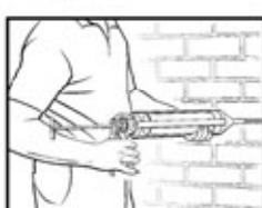
Die Fugenpistole arbeitet wie eine Dichtungspistole. Der Druck auf den Abzugsmechanismus sollte regelmässig sein. Der Mechanismus ist leistungsfähig und benötigt daher keine grosse Anstrengung.
