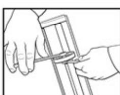
Den Kolben kann man je nach Abnutzung einstellen. Wenn man die Schraubenmuttern fester anzieht, passt sich der Gummi besser im Rohr an.
