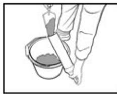
Füllen Sie das Rohr und legen Sie es in die Pistole. Ziehen Sie den Abzug bis der Kolben das Material berührt. Die Pistole ist jetzt arbeitsbereit.
