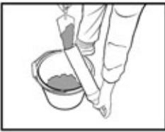
Remplir le fût. Le mortier ne peut être extrudé à travers l'orifice de la buse grise. Si nécessaire ajuster l'ouverture en coupant à la longueur voulue l'extrémité de la buse.
