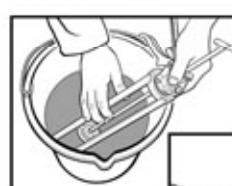
Waschen Sie die Pistole jeweils nach jedem Gebrauch und versichern Sie sich, dass kein Mörtel im Mechanismus ist. Nach dem Waschen tragen Sie ein wenig Öl auf den Mechanismus auf. Dies garantiert einen zuverlässigen und leistungsfähigen Arbeitsablauf.
