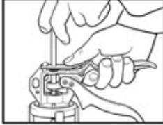
Empuje la placa de descarga en la parte posterior de la pistola, jale la barra T hacia atrás hasta que el émbolo salga del barril y remueva el barril. Si el émbolo se atasca es porque está seco, sólo vierta un poco de agua en el cilindro.
