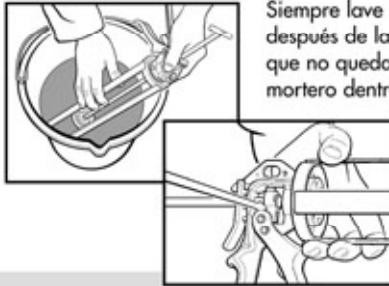
Siempre lave la pistola inmediatamente después de la utilización, asegurándose que no quedan partículas de lechada ni mortero dentro del mecanismo. Una ligera aplicación de aceite en el mecanismo después de la limpieza asegurará un confiable y eficiente funcionamiento.
