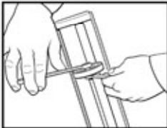
El émbolo se adapta al uso. Ajustando las tuercas, el plástico es estrechado para adoptar el ajuste requerido en el interior del barril.
