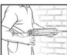
Le pistolet pour injection de ciment fonctionne comme un pistolet à mastic. Appuyez de façon régulière sur la gâchette. Grâce à son puissant mécanisme, ceci ne requiert aucun effort physique.
